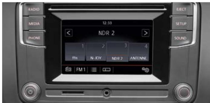
La radio **"Composition Colour"** con display touchscreen a colori da 5" e otto altoparlanti, lettore CD in grado di supportare i formati MP3 e WMA, è dotata di uno slot per schede SD e di una presa AUX-IN. **C**
