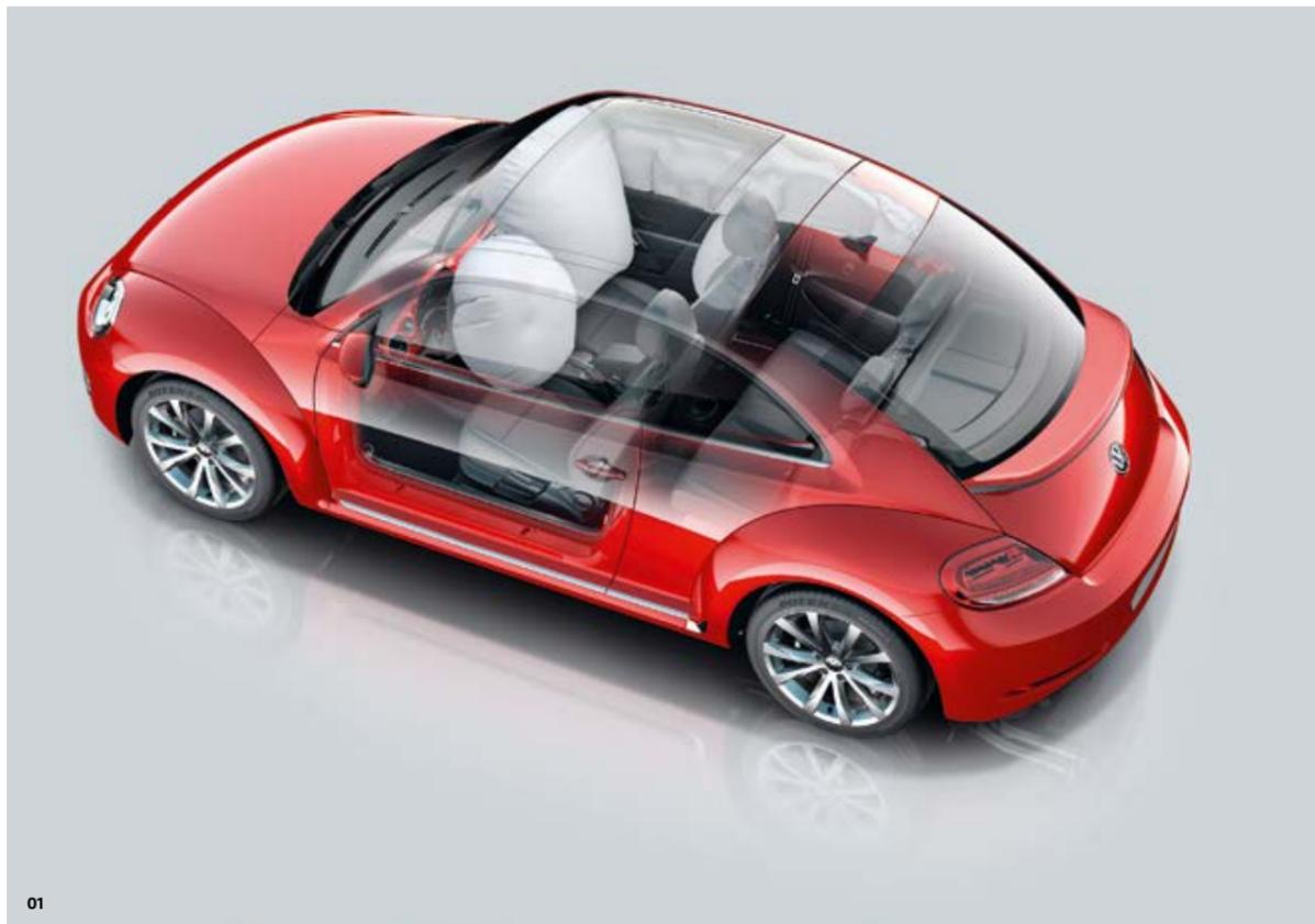
**01** Il sistema di airbag comprende: airbag frontali per il conducente e il passeggero anteriore, con possibilità di disattivazione per quest'ultimo, e un sistema combinato di airbag laterali anteriori per la testa e il torace. In caso di collisione gli airbag vengono attivati entro pochi millisecondi, riducendo notevolmente il rischio di lesioni, in particolare al collo ed alla nuca. **D** **SP**
