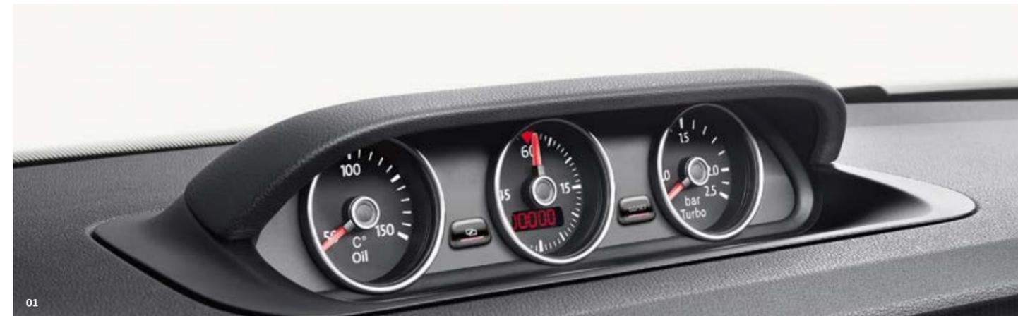
**01** La strumentazione integrativa al centro della plancia indica la temperatura dell'olio di sovralimentazione e dispone, inoltre, di un cronometro multifunzionale che può rilevare i tempi di sosta e di percorso. Come per tutti gli strumenti della plancia, l'illuminazione bianca offre un'ottima visibilità in qualsiasi condizione di luce ambientale. **0**
